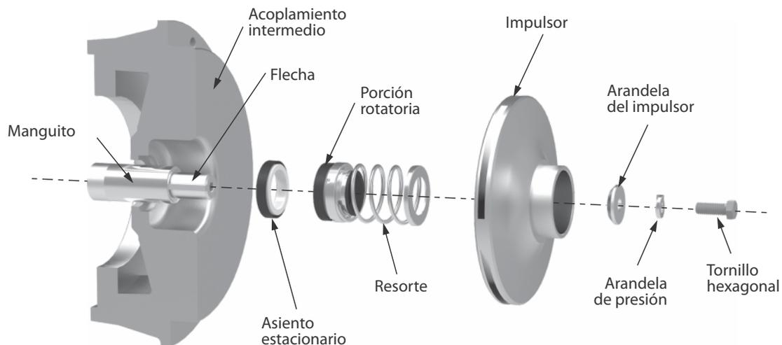
**Figura 8** Sello mecánico - Vista seccional.
