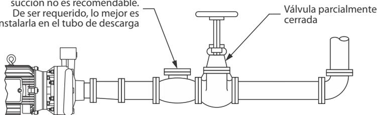
► **Tubería de descarga**
