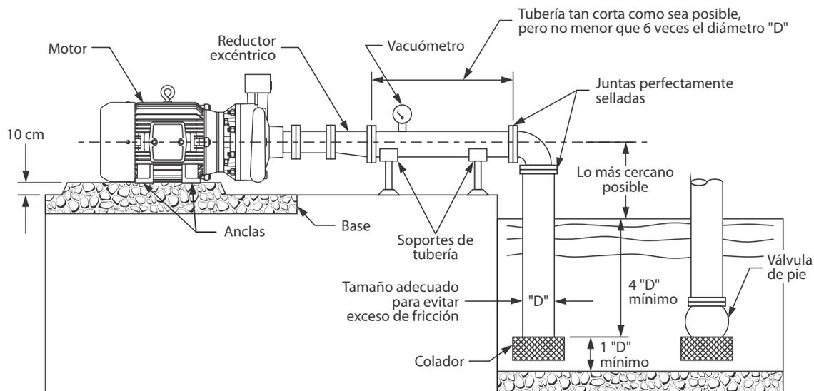
**Figura 2** Instalación incorrecta.
