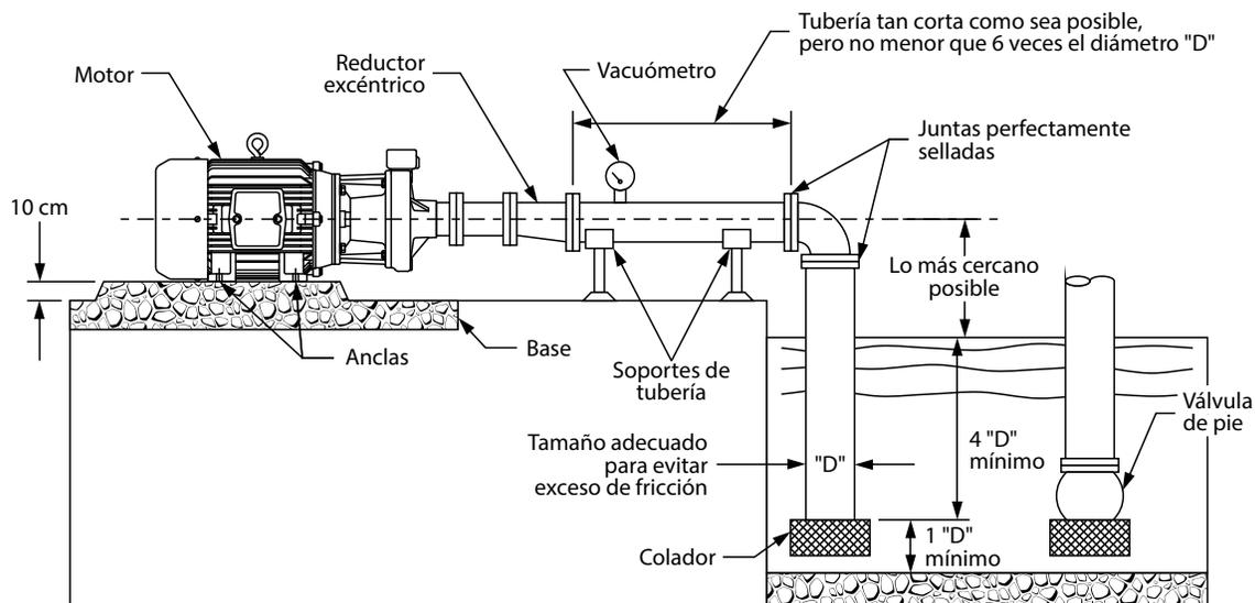
**Figura 2** Instalación incorrecta.
