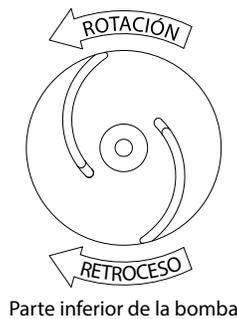
El retroceso debe ser siempre en sentido contrario a las manecillas del reloj, visto desde el motor, o contrario a la rotación del impulsor, la cual a su vez deberá ser contraria al sentido de giro de las manecillas del reloj, visto desde la base de la bomba.
