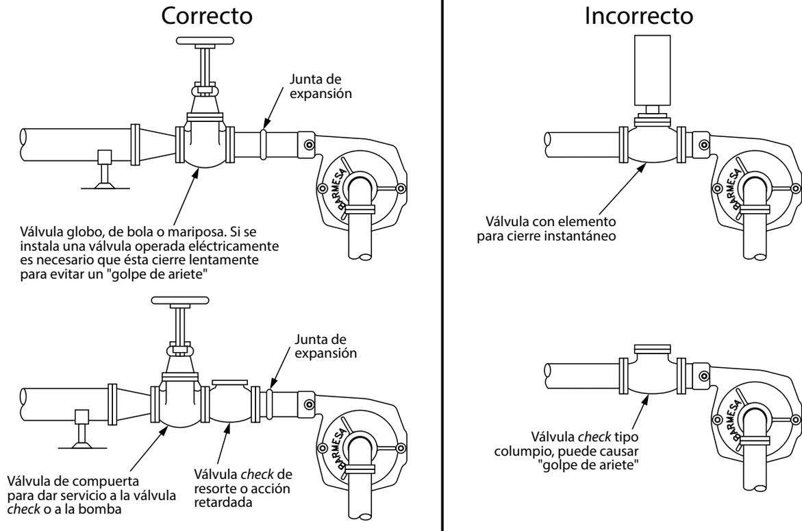
Para determinar el tamaño óptimo de tubería, compare el costo total de operación del equipo (costo de la bomba, equipo de control, tubería, y consumo de energía). Al aumentar el diámetro de descarga razonablemente, se reduce el BHP requerido, ya que baja la fricción. Realice diferentes comprobaciones utilizando varios diámetros de tubería hasta encontrar el que más le convenga.
