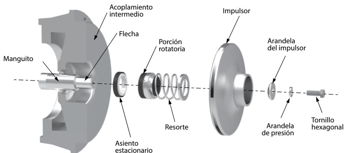
**Figura 8** Sello mecánico - Vista seccional.
