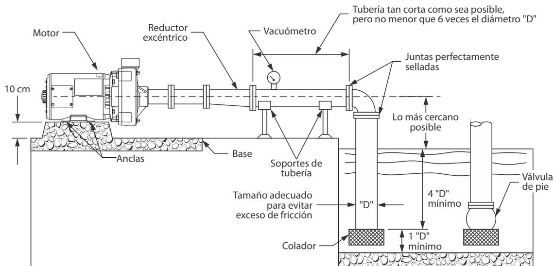
**Figura 2** Instalación incorrecta.
