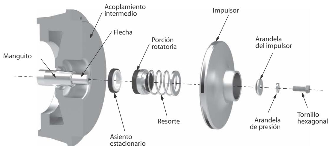
**Figura 8** Sello mecánico - Vista seccional.
